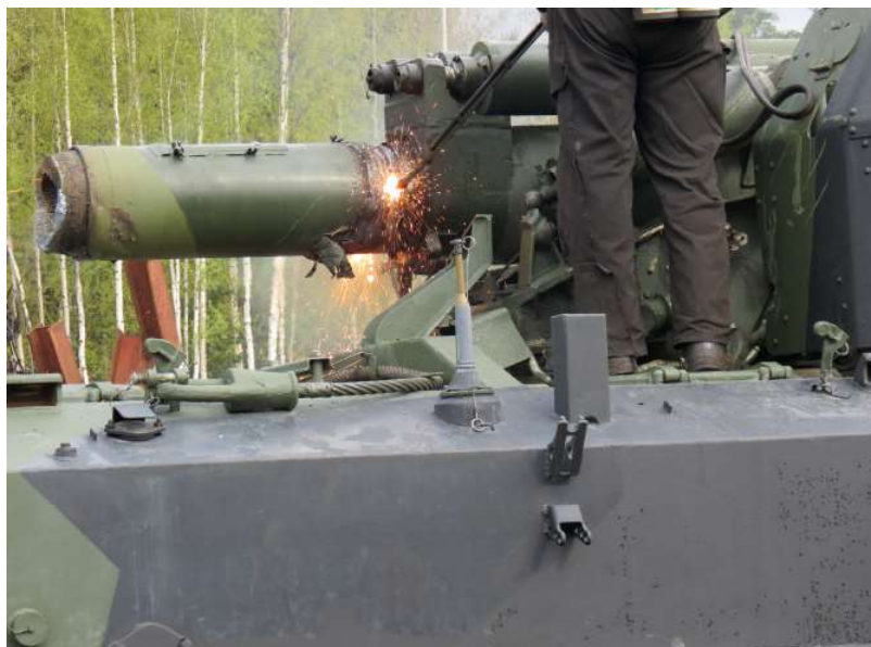
Telakanuunan putken polttoleikkaus Kuusakoski Oy:llä. (Kuva: Tuomo Ali-Vehmas 2015)
